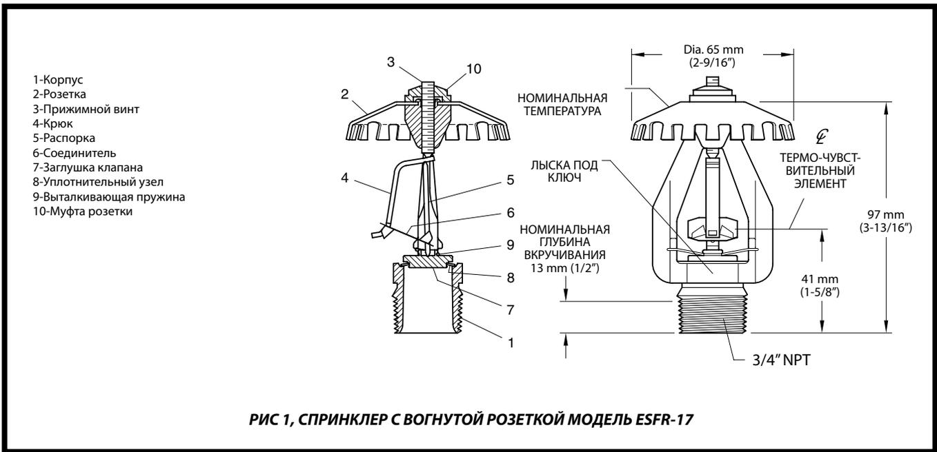
РИС 1, СПРИНКЛЕР С ВОГНУТОЙ РОЗЕТКОЙ МОДЕЛЬ ESFR-17
