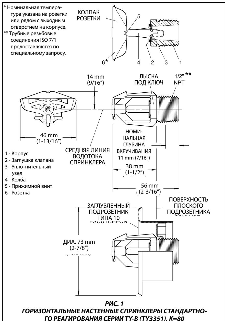
1/2" NPT – 29 Nm (21 ft.lbs). Большое усилие может искривить спринклерное входное отверстие и привести к протеканию или повреждению спринклера.
